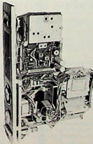
„SLOOP Chassis“ voor de liefhebber. Bevat o.a. Motor afstemming, VHF-UHF Kiezer- HF print- Div. Relais- Trafo- Hoge Tonen Lsp. enz. f 27,50
